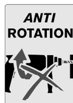
Afin de limiter les effets de retour de couple, l'appareil est équipé d'un débrayage de sécurité (Anti-Rotation).
