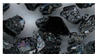
**1C** - Carburo de silicio negro, muy duro, pero menos frágil que el C. Se emplea para mecanizar materiales ferrosos y no ferrosos de baja resistencia a la tracción. Por ejemplo: fundición gris, latón, bronce, aluminio, etc.
