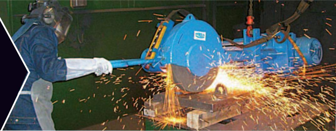
La dureza de un cuerpo abrasivo es la resistencia con que quedan ligados cada uno de los granos abrasivos por la liga, o mejor dicho, la resistencia que ofrecen los granos abrasivos a desprenderse de la liga.
