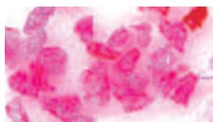
**91A** - Corindón especial rubí con 97%  $Al_2O_3$  y 2%  $Cr_2O_3$ . Este abrasivo es muy duro, pero por su contenido de  $Cr_2O_3$ , menos frágil que el 89A. Es muy adecuado para el rectificado de piezas de acero de muy alta aleación, en donde se exige que la pieza a trabajar no tome elevada temperatura.
