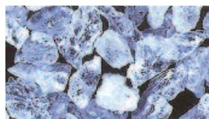
**89A** - Corindón superior blanco con 99%  $Al_2O_3$ . Abrasivo muy duro y frágil. Es el abrasivo más utilizado para el afilado de herramientas de corte (aceros al carbono y rápido), así como para el rectificado de precisión en aceros templados e inoxidables.
