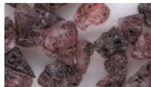
**52A** - Corindón intermedio con aproximadamente 98%  $Al_2O_3$ . Este abrasivo es duro, pero menos tenaz que el 10A. Es muy indicado para trabajos de desbaste de aceros templados y sensibles al calor (incluso aceros resistentes a los ácidos y a la oxidación).
