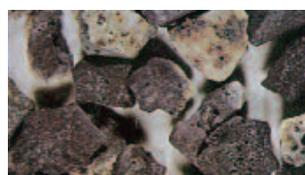
**21A** - Corindón artificial con un 25% de óxido de circonio ( $ZrO_2$ ). La característica principal de este abrasivo es su alta resistencia mecánica, térmica y química; recomendado para el desbaste de aceros y fundición en donde se requiere un alto poder de remoción.
