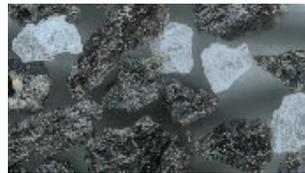
**50A** - Combinación de 10A y 89A, se emplea generalmente para el rectificado exterior entre centros y sin centros de aceros de baja y mediana aleación, con o sin tratamiento térmico.
