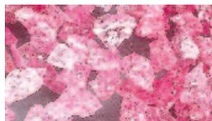
**88A** - Corindón superior rosa, con 99%  $Al_2O_3$ . Este abrasivo es muy duro, pero menos frágil que el 89A y por consiguiente más resistente en perfiles y contra golpes. Es muy indicado en trabajos de rectificado en aceros de alta aleación y de gran resistencia antes del temple.
