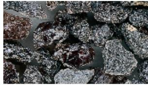
**10A** - Corindón artificial con 95-97%  $Al_2O_3$ . Sus principales características son gran dureza y tenacidad; es el abrasivo más utilizado. Las ruedas fabricadas con este abrasivo se emplean para trabajar aceros de baja aleación sin tratamiento térmico. Particularmente indicado para trabajos de desbaste.
