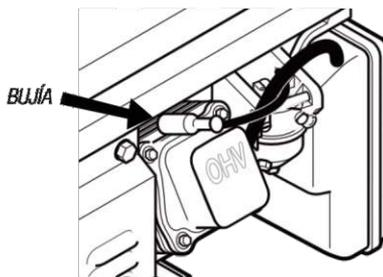
2. Remueva la tapa de la bujía y desatomille la bujía del generador.
