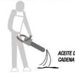
El flujo del aceite de la cadena puede ser modificado de acuerdo a las necesidades de su trabajo. Los cortes de madera seca necesitan mayor cantidad de aceite. Utilizando un destornillador, gire el tornillo ubicado debajo del embrague.
